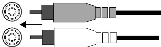
**Se la sorgente del sistema car audio non dispone di uscite livello linea,** utilizzare gli adattatori cavo-per-RCA nudi in dotazione per collegare gli ingressi dell'amplificatore Stadium alle uscite degli altoparlanti anteriori e posteriori dell'autoradio (crimpature a sezione quadrata non incluse).
