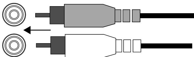
**Om ljudsystemets huvudenhet inte har utgångar med linjenivå** använder du de medföljande adaptrarna för avskalad kabel till RCA för att ansluta Stadium-förstärkarens ingångar till antingen de främre eller bakre högtalarutgångarna på bilens huvudenhet (krympskarv medföljer ej).
