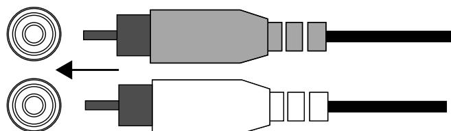
**Si l'unité principale de votre système audio automobile n'a pas de sorties de niveau ligne**, utilisez les adaptateurs de fil dénudé vers RCA fournis pour connecter les entrées de l'amplificateur Stadium aux sorties de haut-parleurs avant ou arrière de l'appareil principal de votre système audio automobile (cosses pour fils dénudés non incluses).
