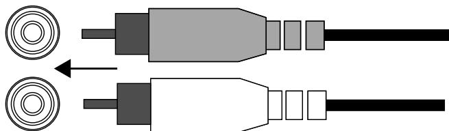
**Hvis hovedenheden i bilens lydsystem ikke har linjeniveauudgange,** skal du bruge de medfølgende ledning-til-RCA adaptere til at forbinde Stadium-forstærkerens indgange til for- eller baghøjttalerudgangene på lydsystemets hovedenhed (splejseklemme er ikke inkluderet).
