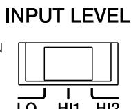
**Remarque:** Si vous avez connecté votre amplificateur aux sorties de haut-parleur d'origine et si le son n'est pas diffusé, basculez le commutateur sur « HI2 ». La position « HI2 » comprend un circuit conçu pour tromper un système audio d'usine en « voyant » un haut-parleur connecté à sa sortie. **Important :** « HI2 » ne doit jamais être utilisé lorsque l'amplificateur est connecté aux sorties de niveau ligne (RCA) d'un appareil principal.
