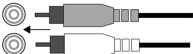
お持ちのカーオーディオ・システムのヘッドユニットがラインレベル出力を有していない場合、付属のRCA変換アダプターを使用して、カーオーディオ・システムのヘッドユニット(スプライス・クリンプスは同梱されていません)のフロントまたはリアスピーカー出力のどちらかを、Stadium(スタジアム)アンプ入力に接続します。
